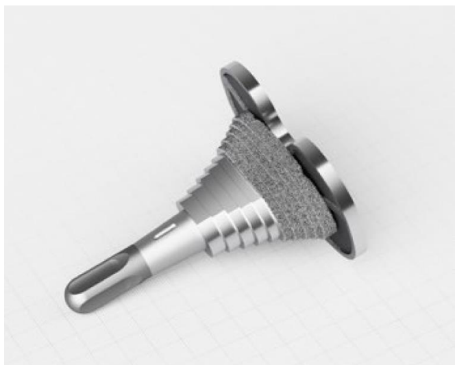
Ryc. 4. Zmontowany konstrukt odpowiadający najgorszemu z możliwych scenariuszy w aparacie 3,0T 20 .
