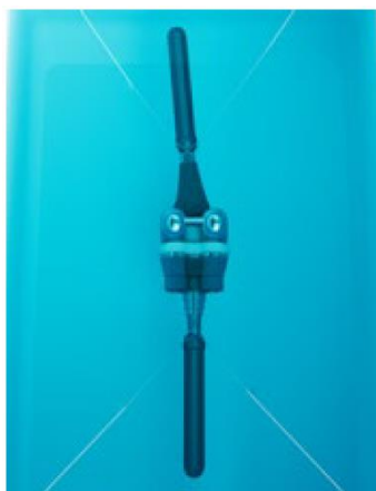
Ryc. 8. Konstrukcja odpowiadająca najgorszemu możliwemu scenariuszowi zanurzony w roztworze siarczanu miedzi zgodnie z normą ASTM F2119 20 .
