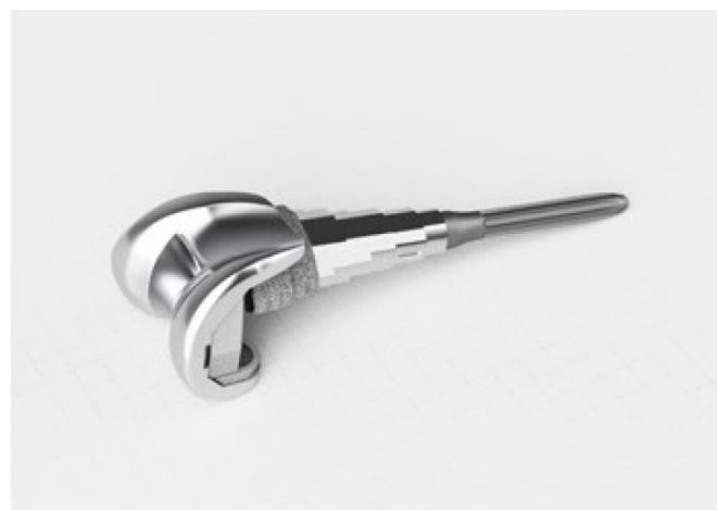
Ryc. 3. Zmontowany konstrukt odpowiadający najgorszemu z możliwych scenariuszy w aparacie 1,5T 20 .
